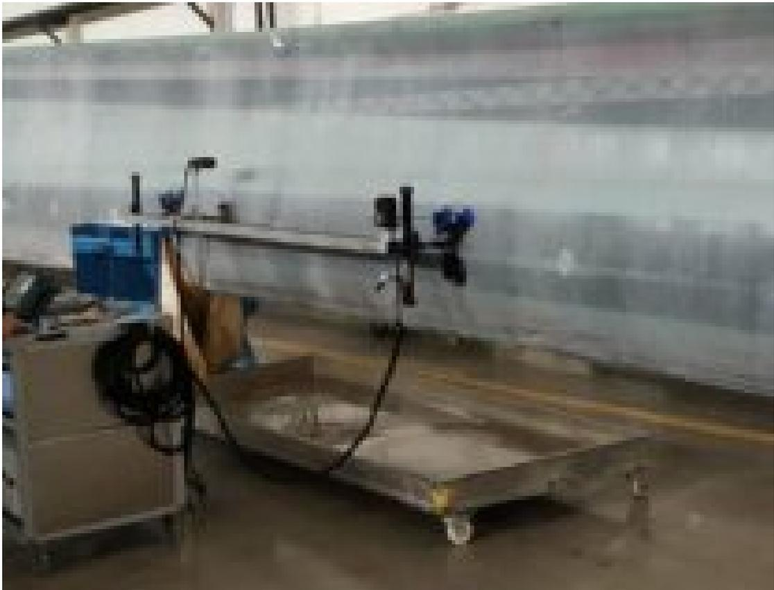
图 1 风电叶片扫查器
